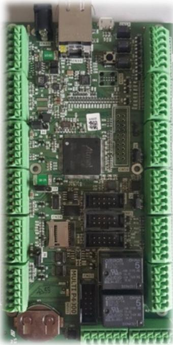
A controladora Multi P4000 foi desenvolvida para gerenciamento de controle de acesso e automação de ambientes. Com suas interfaces Wiegand, RS232 e RS485 permite a integração com diversos tipos de leitores para controle de acesso e o controle de portas, catracas, cancelas, torniquetes e outros dispositivos sem a necessidade de placas adicionais.
